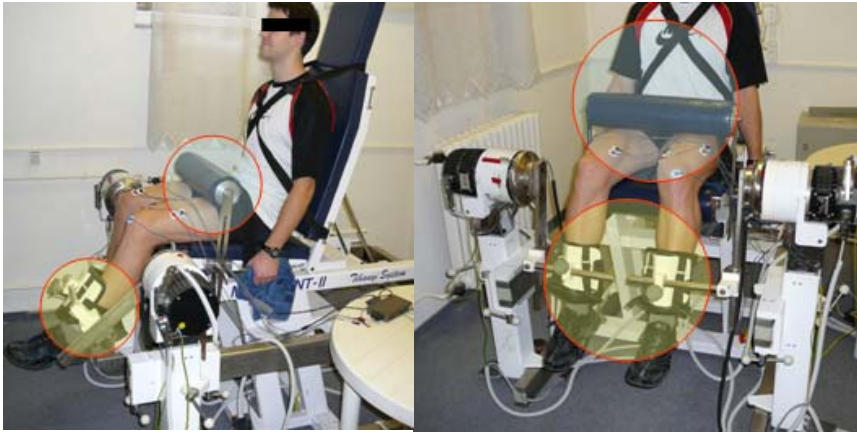
7. ábra. A bilincsek rögzítése az acélkarhoz, a lábszár rögzítése a mandzsettába (sárga árnyalatú kör) és a combok leszorítása az ülőfelülethez (halványkék árnyalatú kör).
